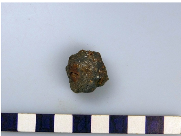
Afbeelding 3.15: niet-metaalslak V144. Het fragment is deels wat roestig, wat op silicaatrijke smeedslak zou kunnen duiden. De schaalverdeling is in cm.
