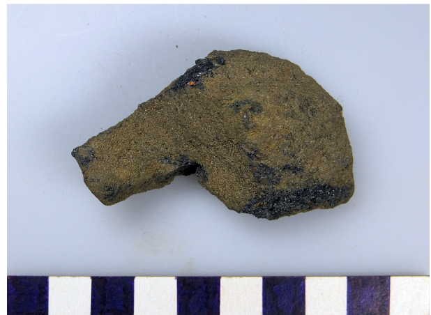
Afb. 4: cokes of steenkool dat door pyrolyse een vesiculaire structuur heeft gekregen. De schaalverdeling is in cm.
