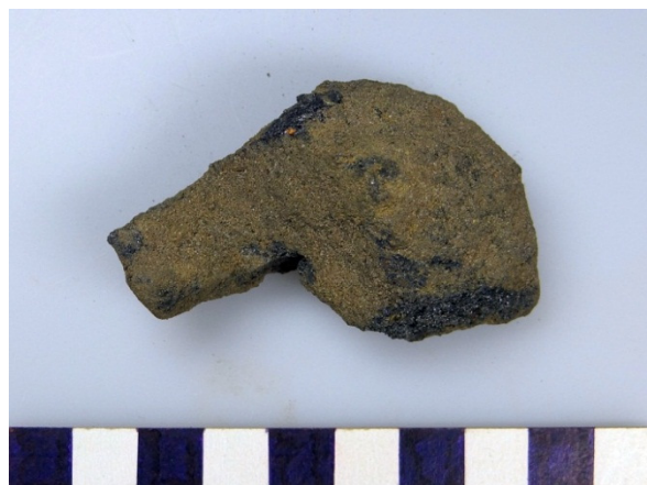
Afbeelding 3.16: cokes of steenkool dat door pyrolyse een vesiculaire structuur heeft gekregen. De schaalverdeling is in cm.
