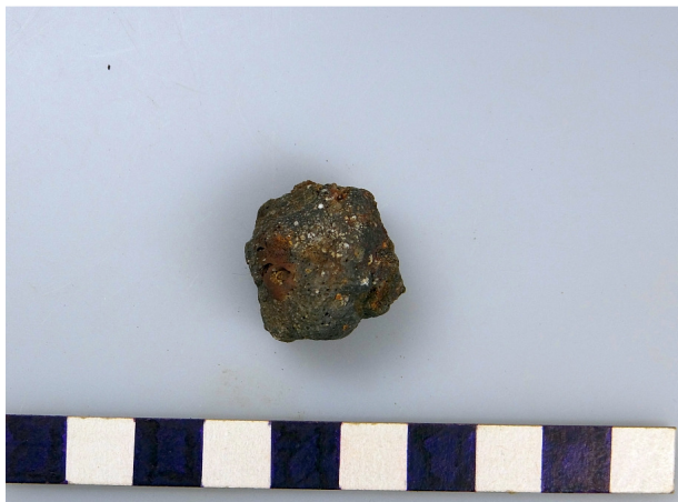
Afb 3: niet-metaalslak V144. Het fragment is deels wat roestig, wat op silicaatrijke smeedslak zou kunnen duiden. De schaalverdeling is in cm.
